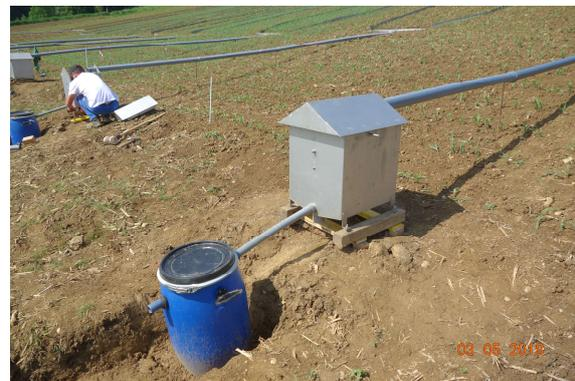
Abbildung 6: Geschlossener Messkasten und Auffangbehälter (Foto: IKT, Brunner)
