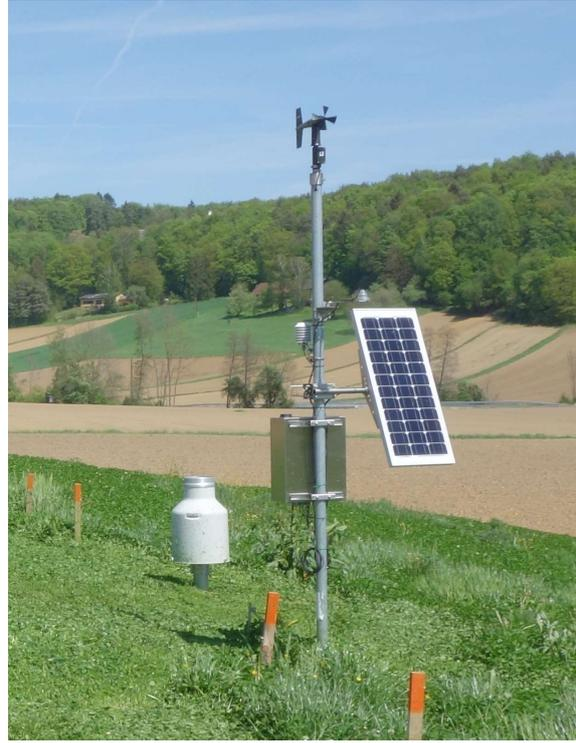
Abbildung 12: Ende 03/2019 errichtete Wetterstation mit Niederschlagswaage im Hintergrund
